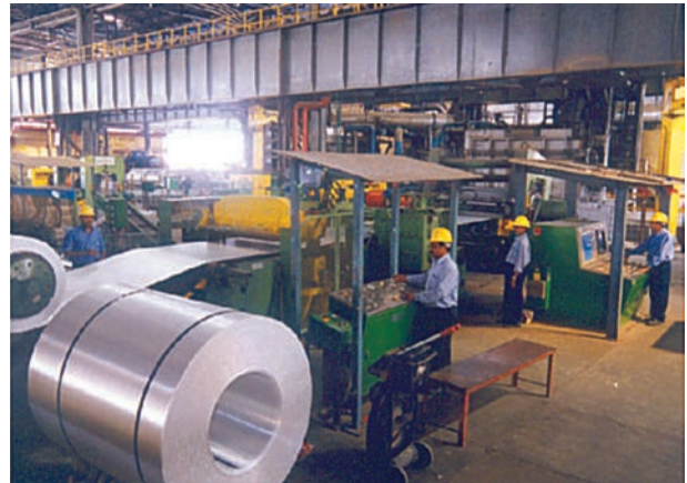
चित्र 6.3 – नाल्को प्रगालक में पट्टी लेप मिल
